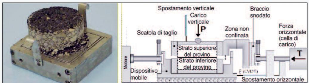
Figura 13 - La prova ASTRA effettuata in laboratorio
