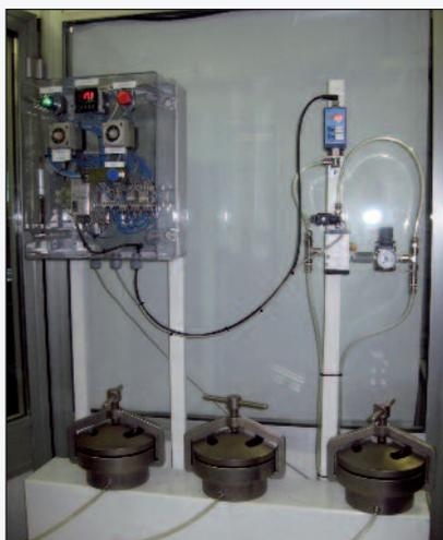
Figura 2 - La prova di tenuta idraulica dopo la compattazione
