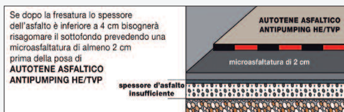
Figura 10 - La posa dell'Autotene Asfaltico Antipumping HE/TPV su una microasfaltatura
