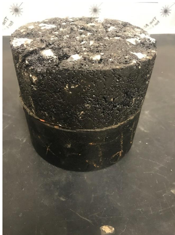
Fase di confezionamento del campione cilindrico per strato inferiore con membrana adesiva Sistema bistrato realizzato
