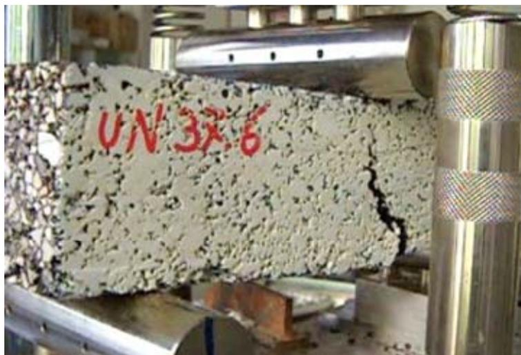
Figura 2.4 – Prova statica di flessione 3PB
