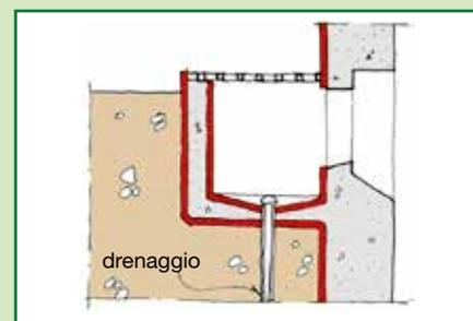
Le scale dovranno essere costruite dopo l'impermeabilizzazione del muro controterra e saranno staccate da questo di almeno 2 cm. Il fondo verrà munito di una griglia di scarico comunicante con la cintura di drenaggio perimetrale.
