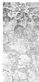
Membrana BIT-SBS dopo 500 cicli
