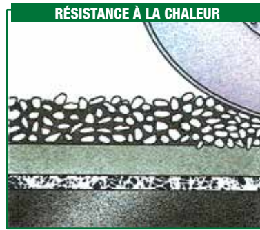
Le point élevé de ramollissement de la face supérieure garantit la résistance à la chaleur de PROTEADUO sur laquelle il est possible d'étaler directement à chaud l'asphalte routier
