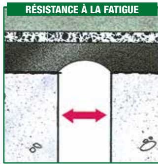
La couche inférieure en bitume-SBS et l'armature en fibre de polyester en fil continu optimisent la résistance de PROTEADUO à la fatigue
