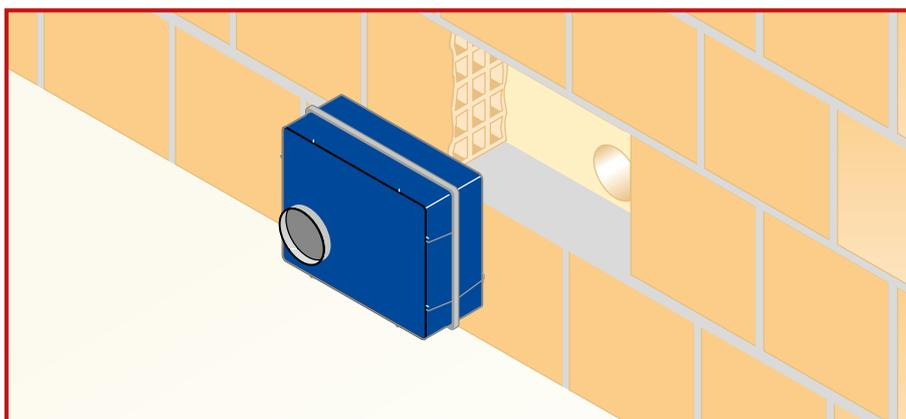
Gli imbocchi dei fori del **FONOPROTEX** su ambedue i lati sono a maschio e di  $\varnothing$  120 mm esterno per essere inseriti in un foro  $\varnothing$  120 o all'interno del tubo  $\varnothing$  125 mm.
