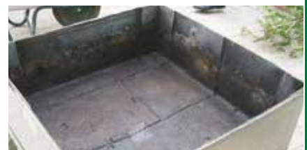
8. Cara superior de DEFEND ANTIRADICE luego de la prueba
