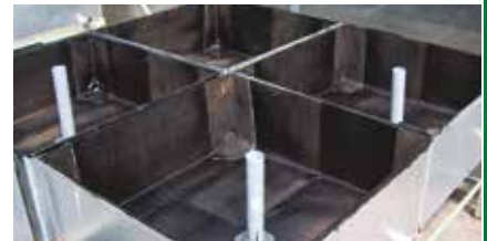
2. Cubas de prueba impermeabilizadas
