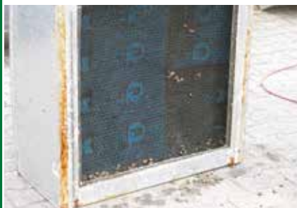
9. Cara inferior de DEFEND ANTIRADICE inalterada luego de la prueba
