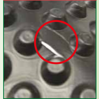
LA CAPA DE HDPE ALMOHADILLADO NO SUPERA LA PRUEBA
