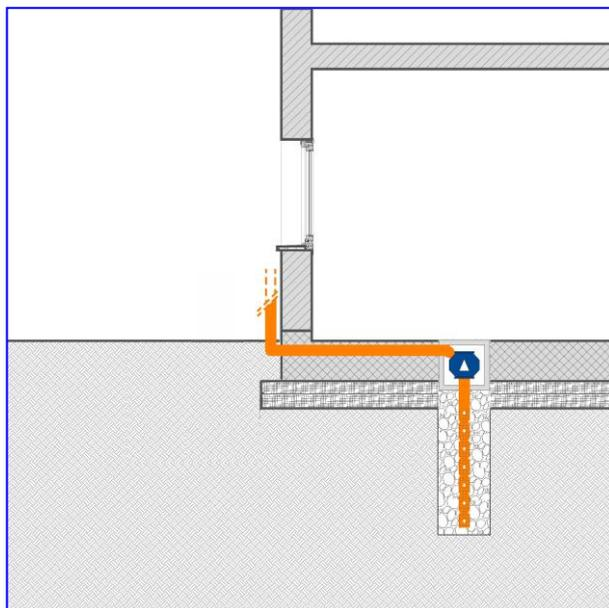
In caso contrario sarà necessario intervenire al perimetro dell'edificio esistente tenendo conto che l'area sulla quale agirà il sistema di ventilazione sarà per metà esterna all'edificio e quindi potrebbero essere necessari più ventilatori per bonificare l'intera costruzione.
