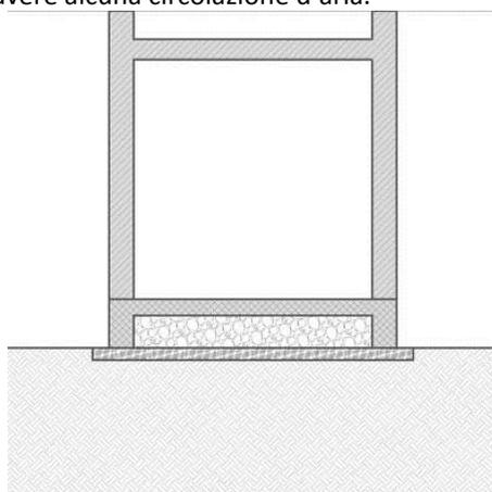
Figura 25: vespaio sotto l'edificio parzialmente o totalmente riempito
