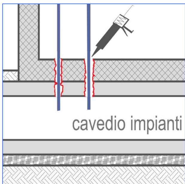
Anche le riprese di getto, le crepe lungo la linea di connessione fra parete verticale e solaio a terra, le fessure passanti nella pavimentazione, ecc. dovrebbero essere preliminarmente sigillate prima di un intervento di bonifica. Si tratta di un intervento quasi sempre di tipo non risolutivo ma finalizzato ad attenuare il flusso di gas verso l'interno e da abbinare poi ad altre tecniche di bonifica.
