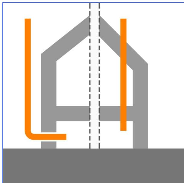
Qualora la presenza di venti dominanti o la differenza di pressione fra interno ed esterno non sia sufficiente a innescare un moto convettivo che richiami il gas del vespaio per disperderlo in quota, sarà necessario inserire un aspiratore nel punto ritenuto più funzionale.
