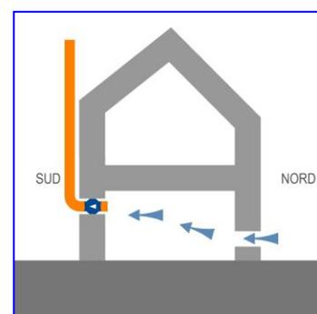
Mentre in caso di ventilazione naturale è indispensabile mantenere aperte una doppia serie di bucatore contrapposte: di ingresso e di uscita dell'aria, per ventilare il volume del vespaio, in caso di ventilazione forzata il più delle volte risulta più conveniente chiudere i fori di ingresso dell'aria per realizzare una maggiore depressione/pressione, nei confronti del terreno. Soprattutto in caso di pressurizzazione.
