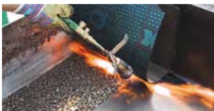
1. Applicazione di DEFEND ANTIRADICE nel dispositivo di prova
