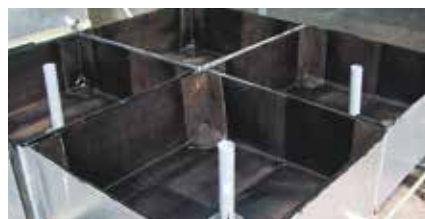
2. Vasche di prova impermeabilizzate
