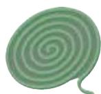
**EXPAN BENTONITICO** è un cordolo idroespansivo in gomma bentonitica, per sigillature in riprese di getto. Rigonfia a contatto con l'acqua, aumentando di volume del 400%, per formare una barriera autosigillante e impermeabilizzante nelle riprese di getto.
