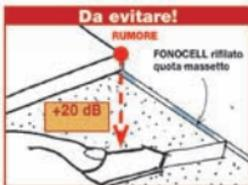
**Posa del battiscopa.** Il battiscopa deve essere posato staccato dalla pavimentazione. Un eventuale contatto del battiscopa con il pavimento causerebbe un ponte acustico danneggiando la riuscita dell'isolamento acustico nell'entità di 3-4 dB nel caso in cui il battiscopa fosse in legno, ma addirittura di 20 dB nel caso di contatto tra pavimento e battiscopa ceramico.
