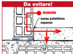
**Sottofondo di riempimento.** Nel sottofondo di riempimento verranno annegate le tubazioni in precedenza posate sul solaio e raccordate con malta cementizia. Il riempimento può essere fatto con calcestruzzo alleggerito o con sabbia stabilizzata con calce o cemento (dosaggio 50÷100 kg/m<sup>3</sup>). Il sottofondo dovrà essere liscio e piano, esente da sporgenze ed avvallamenti. *Un sottofondo irregolare causa uno schiacciamento eccessivo dell'isolante e trasmette il rumore.*
