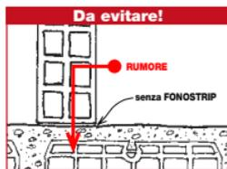
**Isolamento acustico degli impianti.** Fasciare le tubazioni che attraversano il solaio con strisce adesive di materiale elastico. *Un tubo non isolato trasmette il rumore.*
