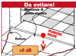
**Giunti di dilatazione.** Prevedere giunti elastici di dilatazione ogni 4-6 m lineari da posizionare preferibilmente in corrispondenza delle soglie. *La mancanza di giunti nel massetto causa la formazione di crepe nel massetto e conseguentemente nella pavimentazione.*
