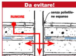
**Desolidarizzazione laterale.** Isolare il sottofondo dai muri con delle strisce adesive di polietilene espanso di 2-3 mm di spessore e di 1-2 cm più alta del sottofondo. *La mancanza della striscia aumenta la trasmissione laterale del rumore.*
