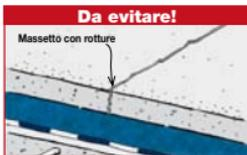
**Giunti in corrispondenza delle soglie.** Prevedere un giunto e una sigillatura elastica fra le pavimentazioni e la soglia di entrata e di accesso alle terrazze. *Un eventuale giunto rigido di malta fra soglia e pavimentazione causerebbe un ponte acustico penalizzando l'isolamento acustico anche di 8 dB.*
