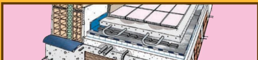
Isolamento acustico dai rumori di calpestio ed isolamento termico dei solai con pavimenti radianti
