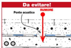
**Sigillatura dei teli.** Sigillare con l'apposito nastro SIGILTAPE le sovrapposizioni laterali e le linee di accostamento con l'apposito nastro adesivo. Non è assolutamente necessario sfiammare con bruciatore. Una eventuale mancanza di sigillatura può far penetrare la malta cementizia creando un ponte acustico.
