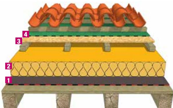
1. SELFTENE BV HE MONOADESIVO ALU POLIESTERE. Barriera vapore, spessore 3 mm con  $\mu > 1.500.000$ .
