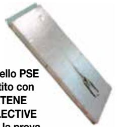
**Pannello PSE rivestito con SELTENE REFLECTIVE dopo la prova**
