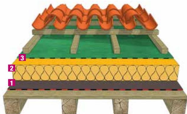
1. SELTENE BV HE MONOADESIVO ALU POLIESTERE. Barriera vapore, spessore 3 mm con  $\mu > 1.500.000$ .
