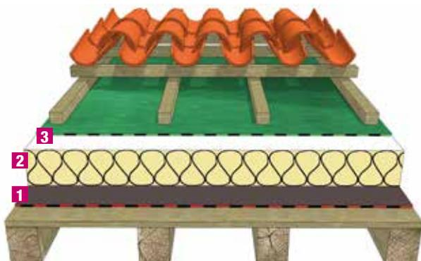
1. SELFTENE BV HE BIADESIVO ALU POLIESTERE. Barriera vapore, spessore 3 mm con  $\mu > 1.500.000$ .
