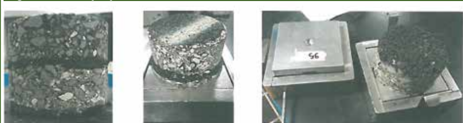
Figura 1 - Provini per prove ASTRA
