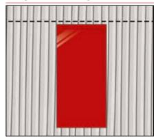
La posa di rivestimenti ceramici con peso superiore alla norma in applicazioni verticali richiede adesivi che consentano facilità di lavorazione, ottima resistenza allo scivolamento e una sicura adesione finale.
