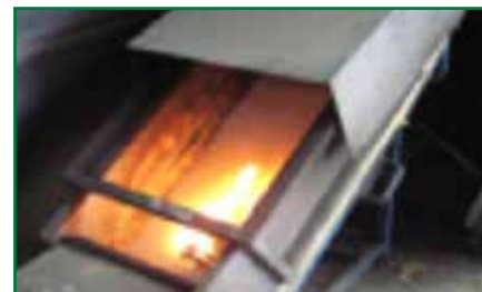
Pannello PSE rivestito con SELTENE REFLECTIVE dopo la prova
