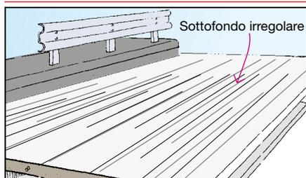
Le superfici delle solette da ponte scabre o irregolari non consentono la corretta adesione delle membrane impermeabilizzanti preformate.
