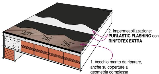
Applicazione di PURLASTIC FLASHING e RINFOTEX EXTRA su membrana bituminosa
