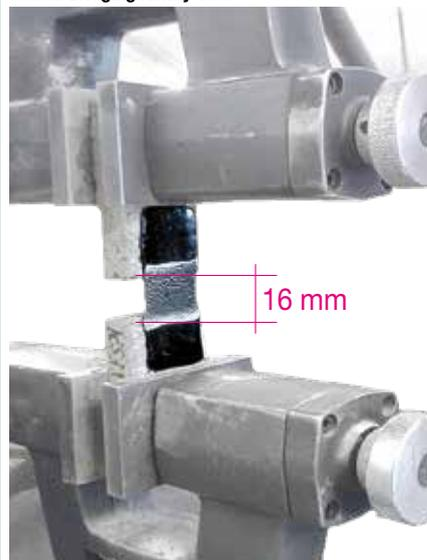
PURLASTIC FLASHING è un prodotto progettato e calibrato per superare il test di "Crack-Bridging Ability" che simula i movimenti dimensionali caratteristici dei sottofondi e garantire la massima tenuta.
