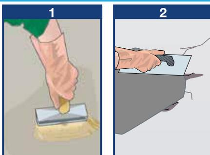
sali superficiali del cemento, i particolari non aderenti, agenti chimici, membrane ritardanti di evaporazione del cemento. Riempire le irregolarità del supporto con idonee malte (2).
