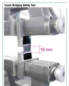
PURLASTIC FLASHING est un produit conçu et calibré pour passer le test « Crack-Bridging Ability » qui simule les mouvements dimensionnels caractéristiques des chapes et pour garantir une résistance maximale.
