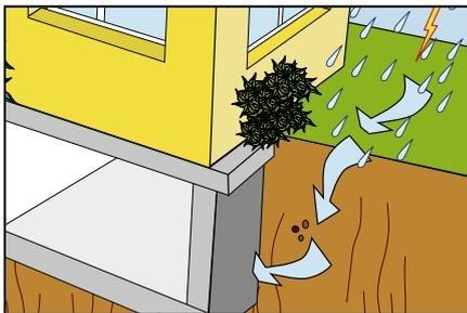
La fonte principale del degrado e quindi dell'inagibilità di locali sotterranei o parzialmente interrati è l'acqua proveniente da infiltrazioni, da falda freatica o da normale umidità stazionante nel terreno su cui poggiano le fondazioni.
