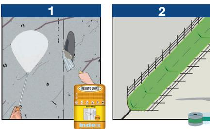
waschen (1). Spuren von Entschalungslösung, Rost und Verschmutzungen im allgemeinen müssen entfernt werden. Auf den Oberflächen darf sich kein Wasser stauen. Beschädigte Teile und Gestücke müssen zuvor mit Mörtel RESISTO TIXO oder RESISTO UNFIX (1) ausgebessert werden, um eine gleichmäßige Oberfläche zu erhalten. An den Verbindungsstellen zwischen vertikalen und horizontalen Bauelementen und in den Dehnungsfugen das Fugenband COVERBAND ADHESIVE oder COVERBAND anbringen (2).
