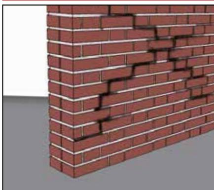
Mauern, die Verfall und Risse durch Erdbeben und geringe Schubfestigkeit aufweisen, müssen eine Armierung erhalten, um ein angemessenes Sicherheitsniveau und eine höhere Widerstandskraft zu gewährleisten.
