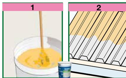
der Film innerhalb einer Stunde nach dem Auftrag trocken; diese Zeit kann jedoch bei sehr hohen Schichtdicken oder sehr niedrigen Temperaturen zunehmen.
