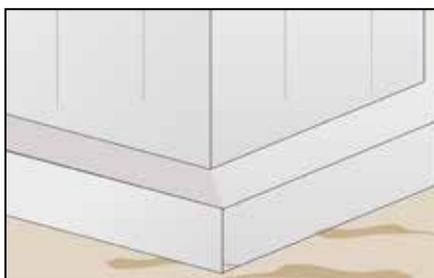
Le strutture in calcestruzzo di fondazioni prive di giunti o edificate su materiali di riporto sono soggette a continui assestamenti, che provocano fessurazioni delle stesse lungo le linee di massima tensione. Si rende quindi necessario l'uso di prodotti bituminosi elastomerici impermeabilizzanti per salvaguardare l'opera da problemi di infiltrazioni quando non è possibile l'impiego di membrane bitume polimero.
