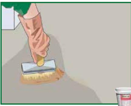
Bei leicht sandenden Oberflächen die verfestigende Grundierung PRIMER FIX auftragen.
