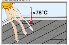
Die mit Bitumenabdichtungen oder Polymerbitumenbahnen ausgeführten Abdichtungen schützen. Darüber hinaus haben mehr als 90 % der Dächer eine dunkle Farbe. Bei Sonneneinstrahlung erwärmen sich die Dachflächen auf Temperaturen von ca. 80°C, die sich negativ auf die Lebensdauer der Dachabdichtungen auswirken.
