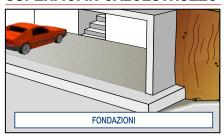
Le strutture in calcestruzzo di terrazze e fondazioni prive di giunti o edificate su materiali di riporto sono soggette a continui assestamenti, che provocano fessurazioni delle stesse lungo le linee di massima tensione. Si rende quindi necessario l'uso di prodotti bituminosi elastomerici impermeabilizzanti per salvaguardare l'opera da problemi di infiltrazioni quando non è possibile l'impiego di membrane bitume polimero.
