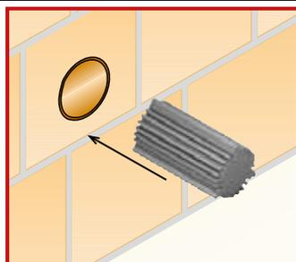
Inserire **FONOPROTEX CYLINDER** all'interno del tubo.
