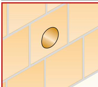
Mit einem Kernbohrgerät auf der verputzten oder nicht verputzten Wand eine Bohrung mit einem Durchmesser von 160 mm vorsehen.
