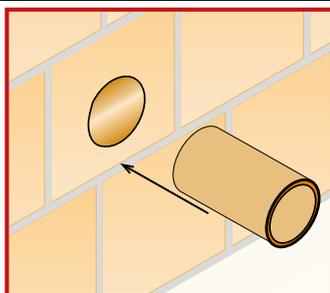
PVC-Rohr (ø 160 mm) in die Bohrung einführen.
