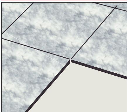
La pose de carreaux de grand et très grand format nécessite l'utilisation d'une colle à épaisseur pour compenser le problème de planéité. Ceci vaut aussi pour les carreaux de forte épaisseur.
