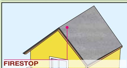
**FIRESTOP** sind feuerbeständige Dichtungsbahnen, die unschädliche anorganische Flammenhemmer enthalten, die in der gesamten Stärke der Bahn verteilt sind. Die Dichtungsbahnen **FIRESTOP** sind das Ergebnis der Forschung von INDEX; sie sind frei von Gegenanzeigen, die für Dichtungsbahnen mit Schutzfolie aus Metall typisch sind und sie können ohne jeden Schutz sowohl auf Flachdächern, als auch auf geneigten Dächern angebracht werden, und auch auf Dämmschichten mit hoher Wärmebeständigkeit.
