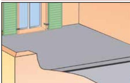
Les membranes liquides imperméabilisantes traditionnelles ne sont pas adaptées pour supporter le piétinement continu et, en général, elles ne résistent pas à des contraintes mécaniques élevées.
