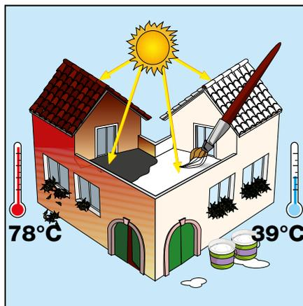
Impermeabilizzare e proteggere dal sole strutture di calcestruzzo a geometria complessa ed articolata dove l'uso di rotoli di membrane bitume polimero prefabbricate risulta difficoltosa e dove la presenza di fonti di calore e fiamme libere aumenta il rischio d'incendio.
