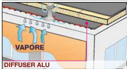
**DIFFUSER ALU POLYESTER** est la membrane de barrière pare-vapeur mise au point par INDEX afin de résoudre le problème de drainage de l'humidité condensée derrière la barrière pare-vapeur.
