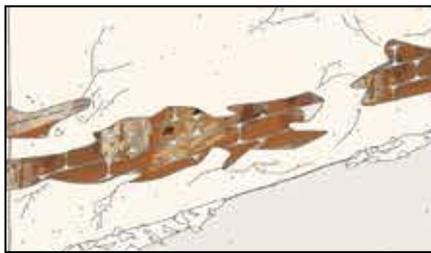
L'umidità e i suoi effetti rendono gli ambienti invivibili e malsani. L'umidità da risalita capillare è un inconveniente che affligge frequentemente le murature di edifici antichi e moderni, provocando il degrado degli intonaci. Questo processo è causato dall'assorbimento per capillarità dei materiali da costruzione porosi a contatto con l'acqua del sottosuolo.
