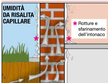
Attraverso le porosità delle murature l'umidità risale per capillarità, trasportando sali quali solfati, cloruri, nitrati ecc, che cristallizzano sulle superfici esterne dando origine ad efflorescenze e provocando distacchi e sfarinamento di intonaci e finiture.
