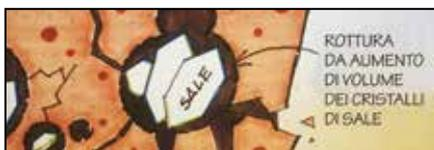
L'umidità da risalita capillare trasporta nel suo cammino elevate quantità di sali, quali solfati, cloruri, nitrati, ecc. che cristallizzano dando origine ad efflorescenze. Le tensioni causate dalla cristallizzazione dei sali provocano lo sfarinamento e il distacco di intonaci e finiture, dovuto all'accrescimento di volume dei cristalli di sale.
