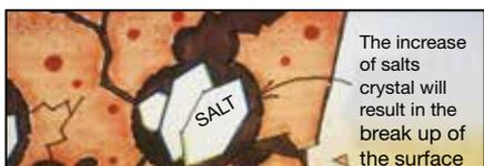
L'humidité ascensionnelle emporte avec elle une grande quantité de sels, tels que les sulfates, les chlorures, les nitrates, etc., qui se cristallisent sur les surfaces extérieures et produisent du salpêtre. Les tensions provoquées par l'accumulation des cristaux de sel provoquent l'effritement et le décrochage des enduits et des finitions.
