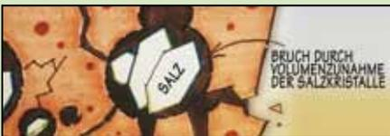
Kapillar aufsteigende Feuchtigkeit transportiert auf ihrem Weg eine große Menge von Salzen, wie Sulfate, Chloride, Nitrate, usw., die sich an den Außenflächen kristallisieren und Ausblühungen verursachen. Die Spannungen bei der Kristallisierung der Salze und ihre Volumenzunahme führen zum Auskremen und Abrieseln von Putzen und Oberflächenbeschichtungen.
