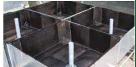
2. Bassins d'essai imperméabilisés
