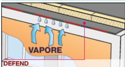
Le membrane della serie **DEFEND** sono usate come strato di barriera al vapore degli isolanti termici nelle coperture edilizie. Sono membrane in bitume polimero elastoplastomero privo di porosità che di per sé costituisce già una ottima barriera alla migrazione del vapore. Si distinguono tre tipologie.
