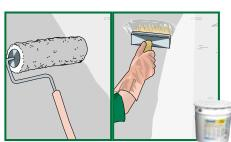
Verdampfungserscheinungen des Zements verzögern, entfernen. Risse und Löcher im Untergrund mit geeignetem Mörtel ausfüllen.
