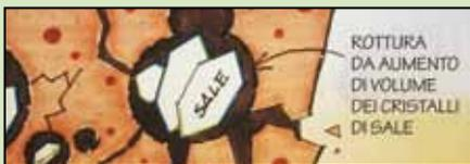
L'umidità da risalita capillare trasporta nel suo cammino elevate quantità di sali, quali solfati, cloruri, nitrati, ecc. che cristallizzano sulle superfici esterne dando origine ad efflorescenze. Le tensioni causate dalla cristallizzazione dei sali provocano lo sfarinamento e il distacco di intonaci e finiture, dovuto all'accrescimento di volume dei cristalli di sale.
