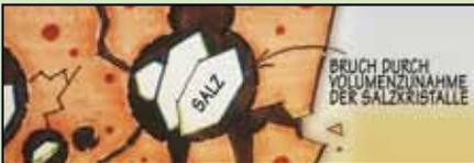
Kapillar aufsteigende Feuchtigkeit transportiert auf ihrem Weg große Mengen an Salzen, wie Sulfate, Chloride, Nitrate, etc., die an den äußeren Oberflächen auskristallisieren und zu Ausblühungen führen. Die durch die Auskristallisierung der Salze erzeugten Spannungen verursachen das Abbröckeln und Ablösen von Putz und Anstrichen, was auf die Volumenzunahme der Salzkristalle zurückzuführen ist.
