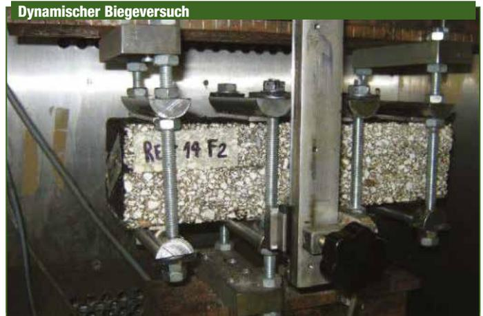
Stärke (entspricht der Stärke von **AUTOTENE ASFALTICO ANTIPUMPING**) auf einer alten gerissenen Fahrbahndecke entspricht einer Verschleißschicht von 19 cm. Man stellte fest, dass bei einer Verschleißschicht von 5 cm, die ohne SAMI auf einer alten gerissenen Fahrbahndecke aufgebracht wird, die Risse nach weniger als 2 Jahren zur Oberfläche durchschlagen. Bei eingebrachter SAMI Einlage beträgt die Nutzungsdauer dieser Schicht voraussichtlich mehr als 10 Jahre.
