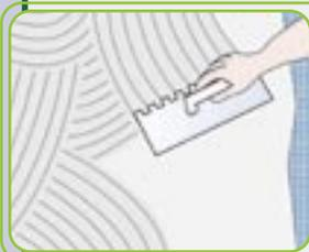
La stesura dell'adesivo in fase di posa delle piastrelle verrà eseguita con spatola dentata da 7 a 3 mm a seconda del formato della ceramica, uniformando lo strato di adesivo senza creare punti in eccesso o in difetto di quantità per non creare onde o problemi di scarsa adesione. Il metodo della doppia spalmatura è il più consigliato per evitare interstizi vuoti. Il consumo di adesivo è di circa 4 kg/m<sup>2</sup>. Adesivi consigliati:
