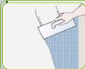
Utilizzare COVERCOL AB RAPID, oppure OSMOLASTIC AB o OSMOFLEX AB, come rasanti impermeabilizzanti su tutte le superfici affogando nella prima mano una rete in fibra di vetro - RETINVETRO PER RASANTI sormontando la rete per 10 cm. Il consumo minimo dello strato impermeabilizzante è di circa 2 kg/m<sup>2</sup>.
