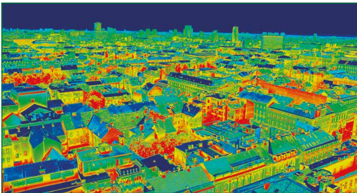
L'immagine scattata con termocamera a infrarossi mette in risalto in rosso e in giallo le zone di dispersione termica degli edifici a causa di inadeguati sistemi di coibentazione.
